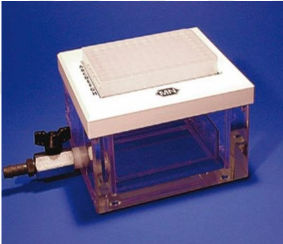
Şekil 3.6. (a) NucleoFast® 96 PCR kiti (MACHEREY-NAGEL GmbH) ile pürifikasyonun yapıldığı otomatik pipetleme sistemi (Liquidator 96, Mettler-Toledo) (b) Vakum manifoldu (NucleoVac 96, MACHEREY-NAGEL GmbH).
