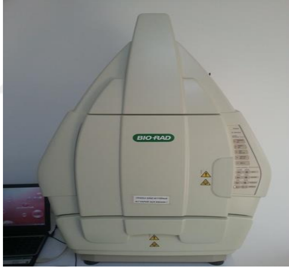
Şekil 3.4. (a) Jel yürütme tankı, (b) Jel görüntüleme cihazı (Biorad-UV Transilluminator)
