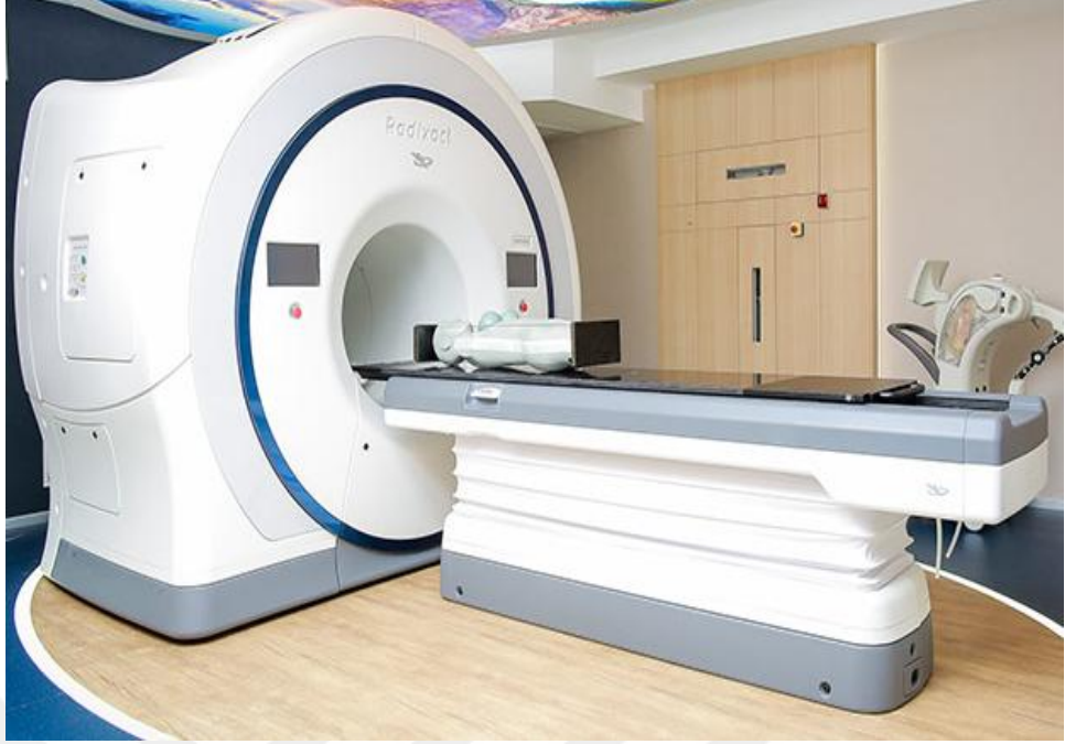
Şekil 3.4. Anadolu Sağlık Merkezi Radixact X9 TM lineer hızlandırıcı cihazı
