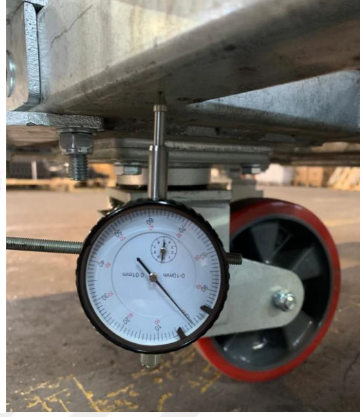
Şekil 4.11. Deformasyonun en az olduğu bölgedeki ölçüm değeri
