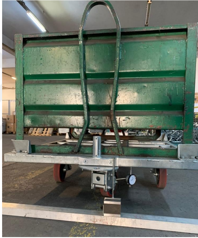
Şekil 4.13. Özel taşıma römorkunun fiziksel test öncesi montajlı ve referans kütlenin yüklendiği hali
