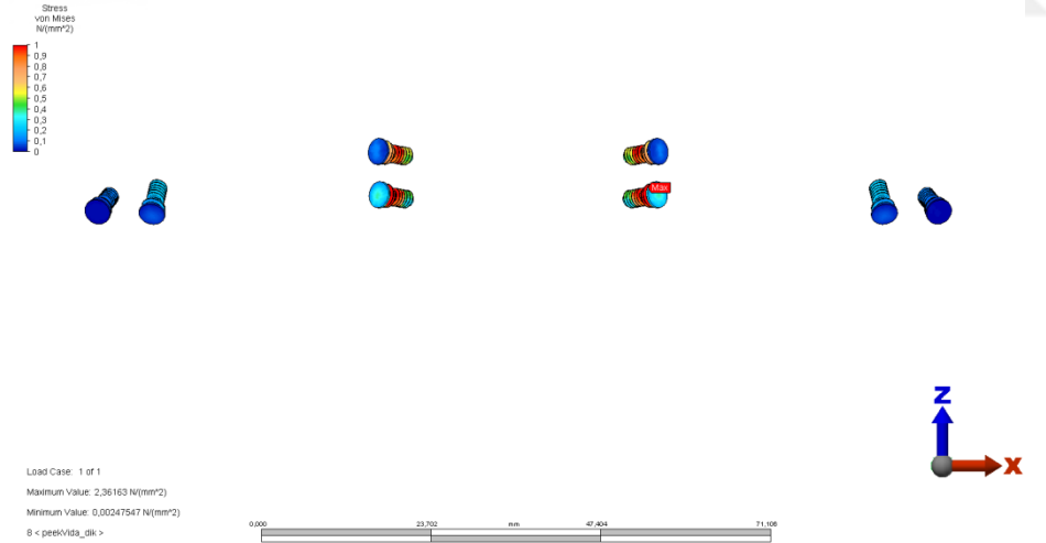
Şekil 4.4. Model 2'deki posterior dik kuvvetlere karşı PEEK fiksasyon vidaları üzerinde oluşan Von Mises Stresler
