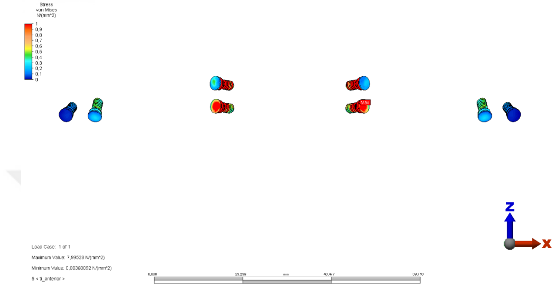
Şekil 4.27. Model 1'deki anterior dik açılı kuvvetlere karşı titanyum fiksasyon vidaları üzerinde oluşan Von Mises Stresler
