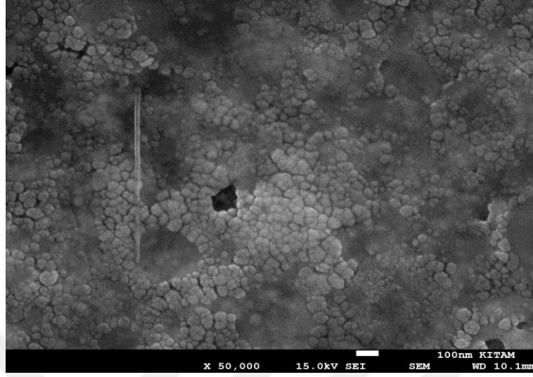
Şekil 4.18. Optimum koşullarda sentezlenen Gümüş nanopartiküllerin SEM mikrografı
