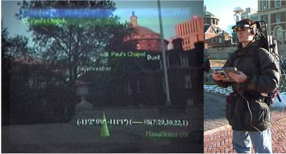
Şekil 2.5 : Tur amaçlı oluşturulan mobil artırılmış gerçeklik sistemi [18].
