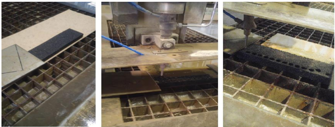
Şekil 3.1. EPP köpük levhanın su jetine yerleştirilmesi, kesimi ve levha üzerinden numune alımı
