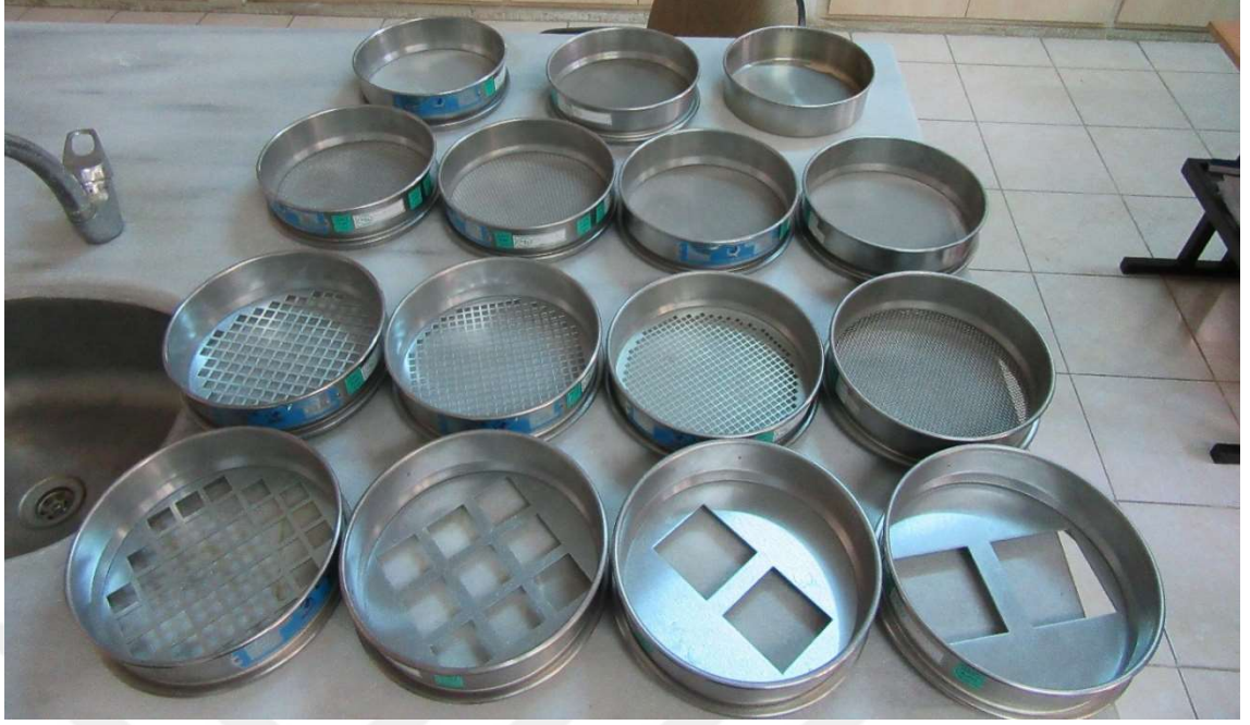
Şekil 3.21. TS EN ISO 17892-4 standardı elek takımı
