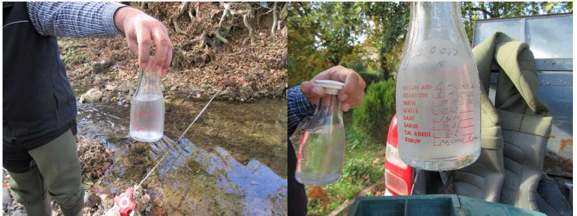
Şekil 3.27. Sediment numunesi alımı sırasında kullanılan tüpler
