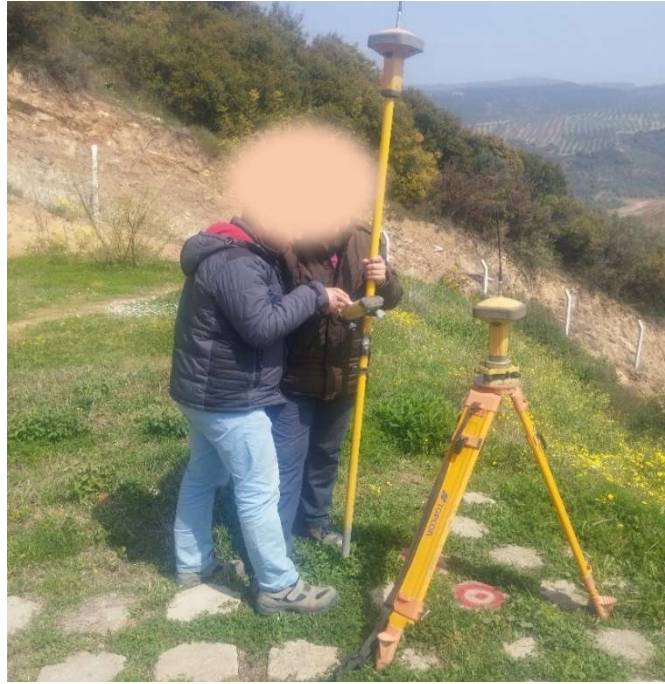
Şekil 3.15. P3 poligon noktasında sabit anten kurulumu
