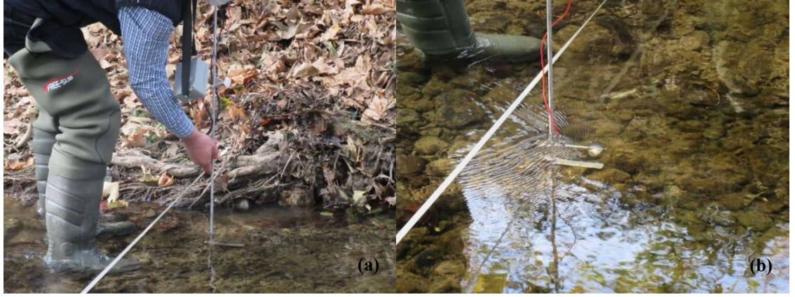
Şekil 3.25. Su derinliği ölçümü ve akım ölçer (muline) yardımıyla kesit hızlarının belirlenmesi
