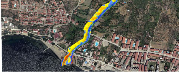
Şekil 4.33. Dere yatağında Ekim 2019 – Eylül 2020 dönemlerinde gerçekleştirilen topografik okumalar arasındaki farkların alansal dağılımları
