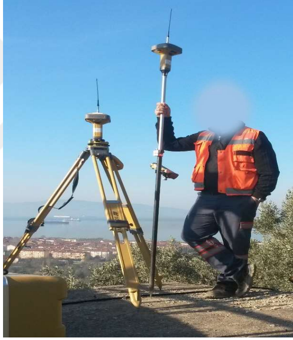
Şekil 3.13. Sabit uydu alıcısı anten ile gezici mobil antenli GPS
