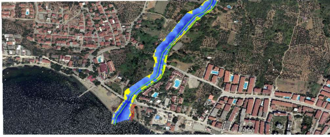
Şekil 4.19. Dere yatağında Ekim 2016 – Mart 2017 dönemlerinde gerçekleştirilen topoğrafik okumalar arasındaki farkların alansal dağılımları
