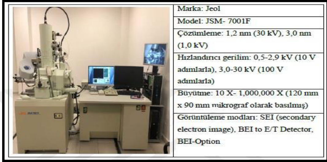
Şekil 3.6. Taramalı elektron mikroskobunun (SEM) görüntüsü ve çalışma koşulları
