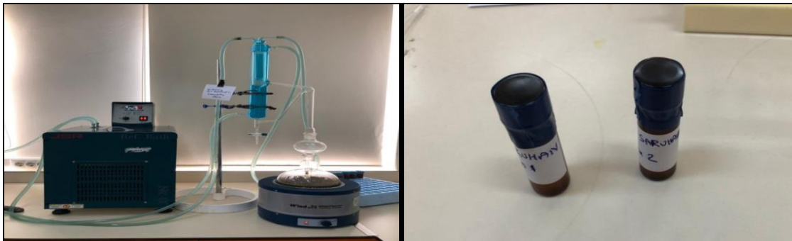
Şekil 6. Çalışmada kullanılan Clevenger düzeneği ve toplanan uçucu yağların renkli şişelere (vial) konulması
