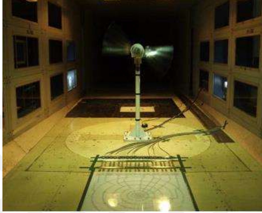
Görsel 5.1. %12 ölçekli model için test kurulumu (Maizi vd., 2018).
