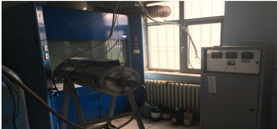
Şekil 3.21 Karbonizasyon işlemlerinde kullanılan borusal reaktör ve çeker ocağı
