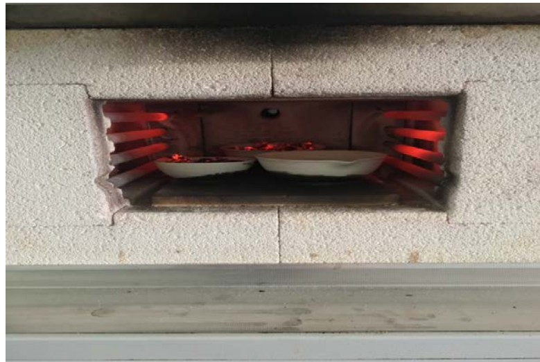
Şekil 3.20. Kül Fırınında numunelerin Kül Tayini.
