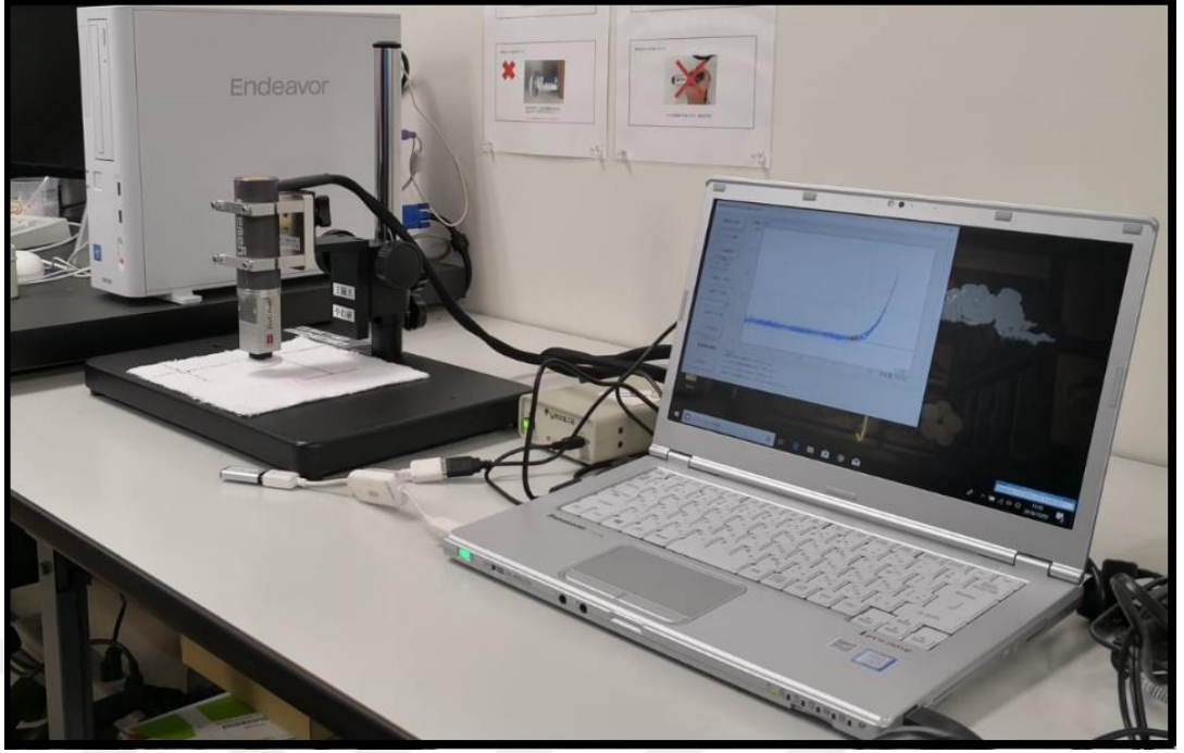
Şekil 5.10. Havlu numunelerinin başlangıç modülü ve modül gradyan değerlerinin ölçüm yapıldığı cihaz
