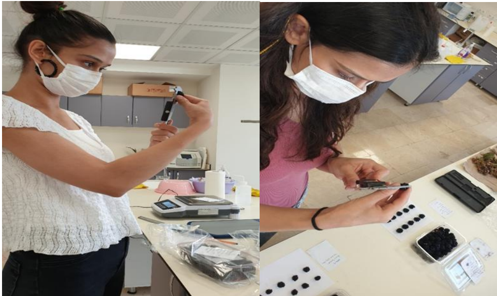
Fotoğraf 3.10. Meyvelerde meyve eni ve boyunun ölçülmesi.
