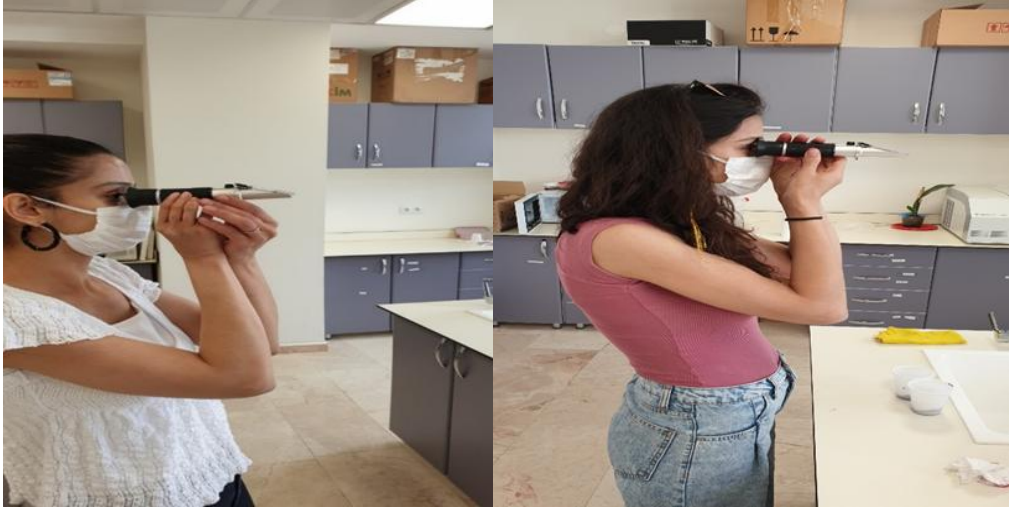
Fotoğraf 3.12. Suda çözünür kuru madde içeriğinin ölçülmesi.
