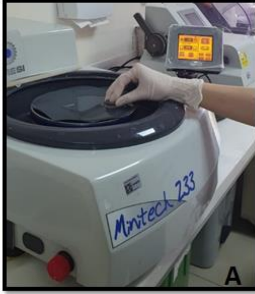
Şekil 3.4. Diş örneklerinin yüzey hazırlık işlemleri A. Diş örneklerinin okluzal yüzeylerinin su soğutması altında alüminyum oksitli ( Al_2O_3 ) abrazyv kağıt diskler kullanılarak polisaj cihazında cilalanması, B. Okluzal yüzeyi cilalanmış diş örneği
