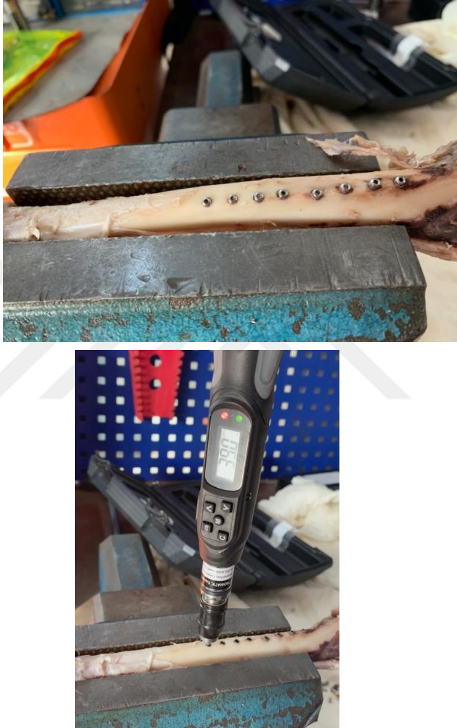
Şekil 7. RTV (Geri çevirme tork değeri) ölçülmesi
