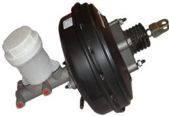
Resim 1.5 Fren Kuvvetlendirici (İnt. Kyn. 5).
