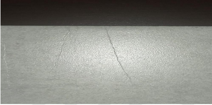
Resim 4.2. Sır ve Bünye Termal Genleşme Farkı Kaynaklı Çatlak Problemi
