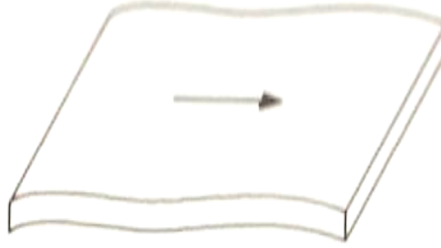
Şekil 4.1. Karo Köşesinin Aşağı Deformasyonu (Sacmi, 2002).
