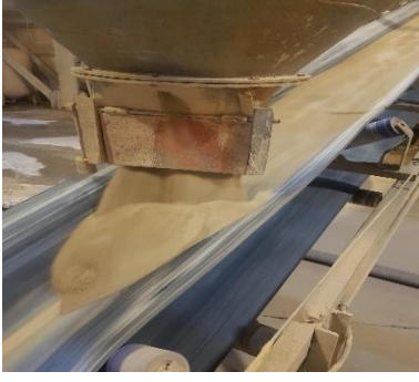
Resim 3.5. Püskürtmeli Kurutucu Masse Çıkış Nozulu
