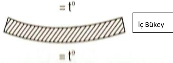
Şekil 4.7. Pişmeye Sonrası Konveks Karo, İç Bükey Hale Gelmesi (Sacmi, 2002).
