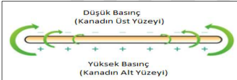
Şekil 3.19. Kanat ucunda oluşan hava akışı
