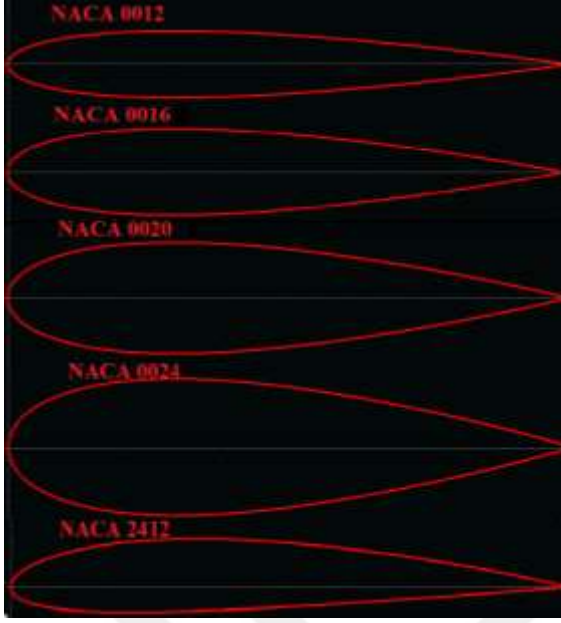
Resim 5.1. Kanat kesitlerinin çizimleri
