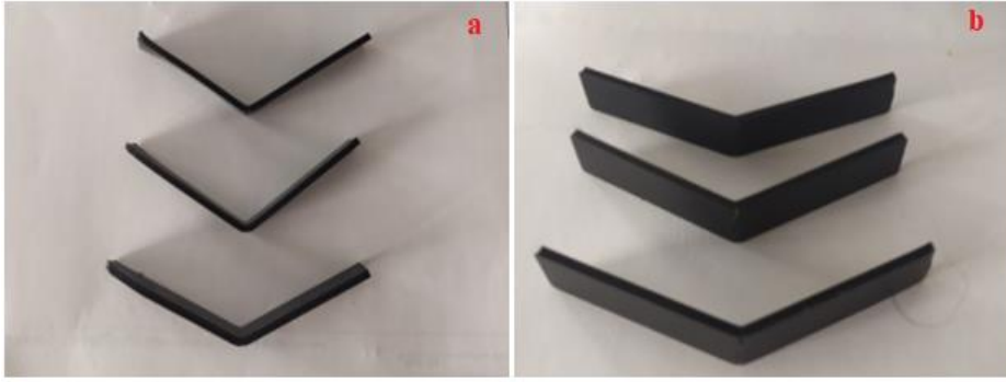
Şekil 4.23. Eğme testi sonrası a) H marka test numuneleri b) I marka test numuneler
