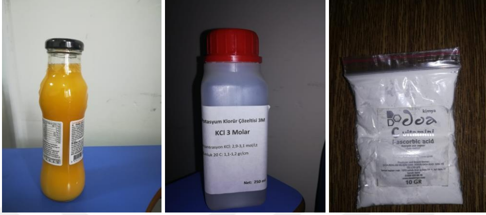
Şekil 4.9. Askorbik asit ölçümünde kullanılan kimyasallar (en solda: taze sıkılmış portakal suyu, ortada: 3M KCl çözeltisi, en sağda: askorbik asit )
