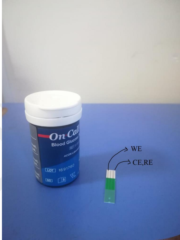
Şekil 4.6. Deneyde kullanılan On-Call plus adındaki elektrotlar
