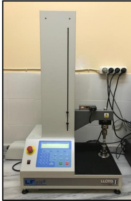
Şekil 3. 21. Mikrogerilim bağlanma dayanımı testinde kullanılan universal test cihazı
