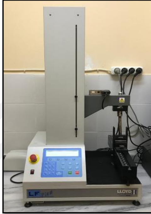
Şekil 3. 14. Bükülme dayanımı testinde kullanılan üniversal test cihazı
