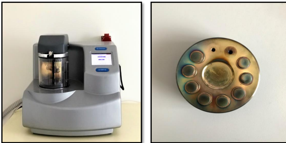
Şekil 3. 12. Quorum Q150R ES altın kaplama cihazı ve Au-Pd kaplanan örnekler
