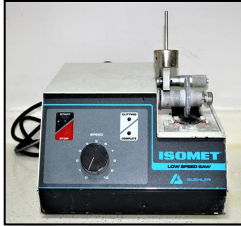
Şekil 3. 18. Isomet 1000 Buehler düşük devirli hassas kesme cihazı
