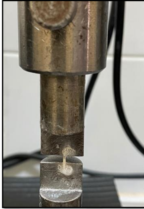
Şekil 3. 22. Üniversal test cihazına bağlanmış çubuk şekilli örnek
