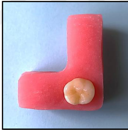
Şekil 3. 15. Soğuk akriliğe gömülmüş diş
