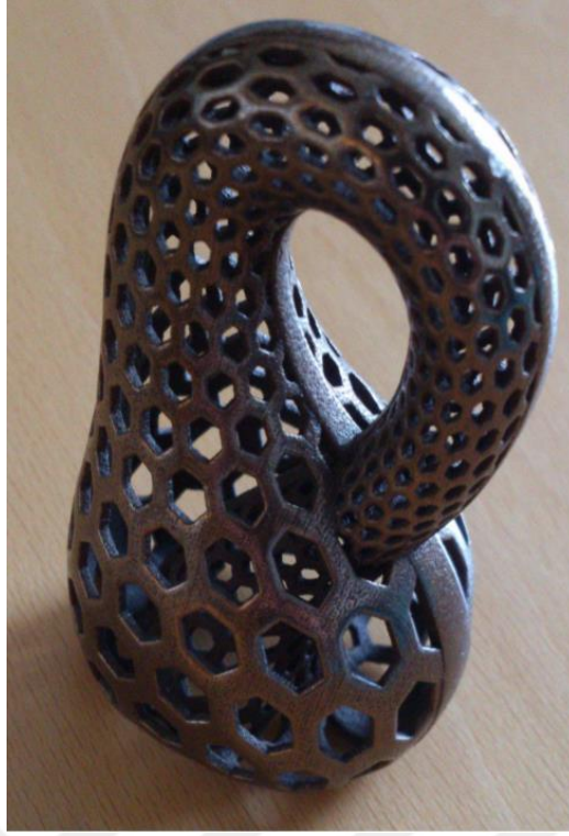
Şekil 9. Toz yatağı işlemi kullanılarak üretilen Klein şişesi
