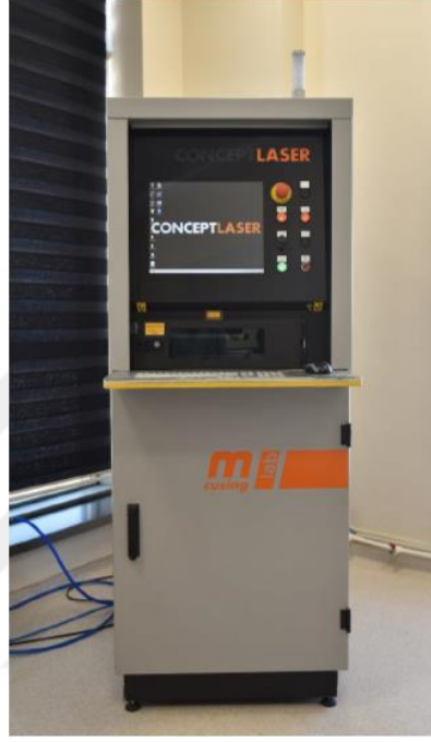
Şekil 21. Örneklerin üretildiği Concept Lazer MLab R cusing SLE üretim cihazı.
