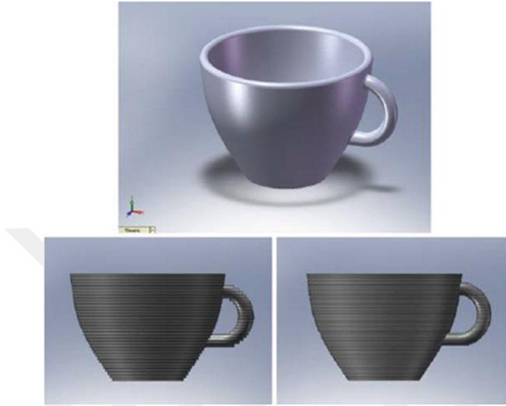
Şekil 4. Farklı katman kalınlıkları kullanarak inşa edilen gösteren bir çay fincanının CAD görüntüsü
