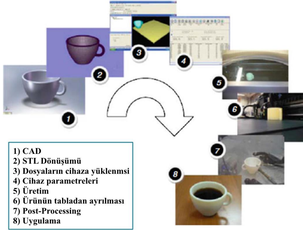
Şekil 5. CAD tasarımı yapılan modelin genel üretim süreçleri
