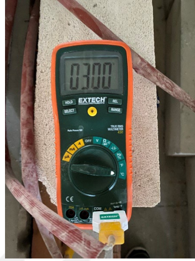
Şekil 5.12 a) Numune-3 60. dakikadaki alt yüzey dış sıcaklık değeri b) Numune-3 60. dakikadaki Termokupl-3'teki iç sıcaklık değeri
