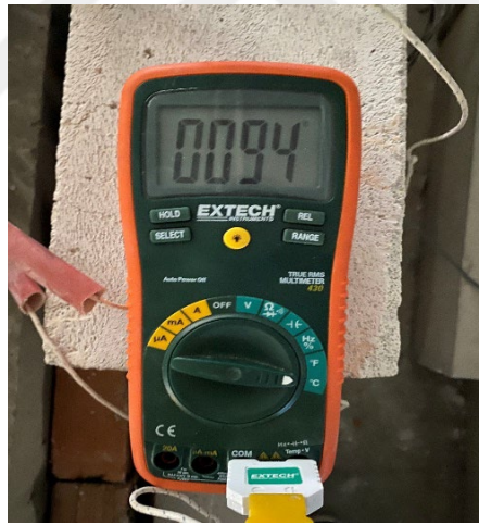
Şekil 5.13 Numune-4 için 45. dakika iç ve dış sıcaklık değerleri
