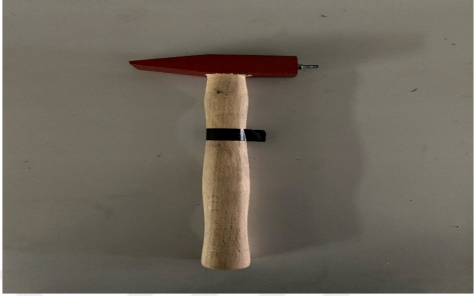
Şekil 5.6 Serbest titreşim deneyleri için kullanılan darbe çekici
