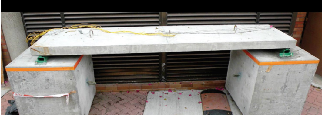
Şekil 1.7 Uzun açıklı köprülerin titreşim özelliklerini simüle etmek için bir test düzeneği (Zhou and Yi, 2014)
