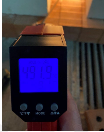
Şekil 5.12 a) Numune-3 60. dakikadaki alt yüzey dış sıcaklık değeri b) Numune-3 60. dakikadaki Termokupl-3'teki iç sıcaklık değeri
