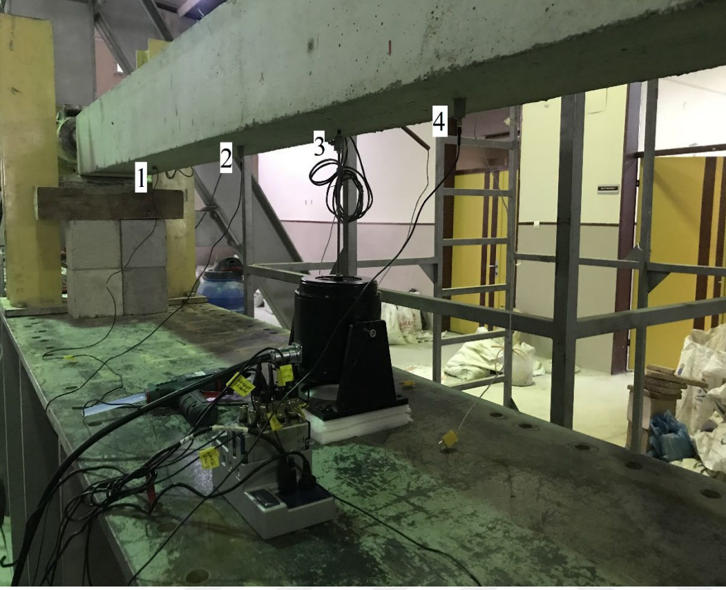
Şekil 5.5 İvmeölçerlerin yerleri ve kuvvet sensörü 1) İvmeölçer-1 2) İvmeölçer-2 3) Kuvvet sensörü 4) İvmeölçer-3
