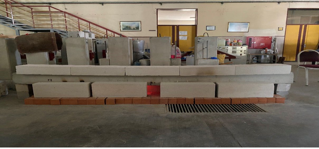
Şekil 5.15 Numunelerin deney sonunda yerçekimi yönünde hafif eğilmesi
