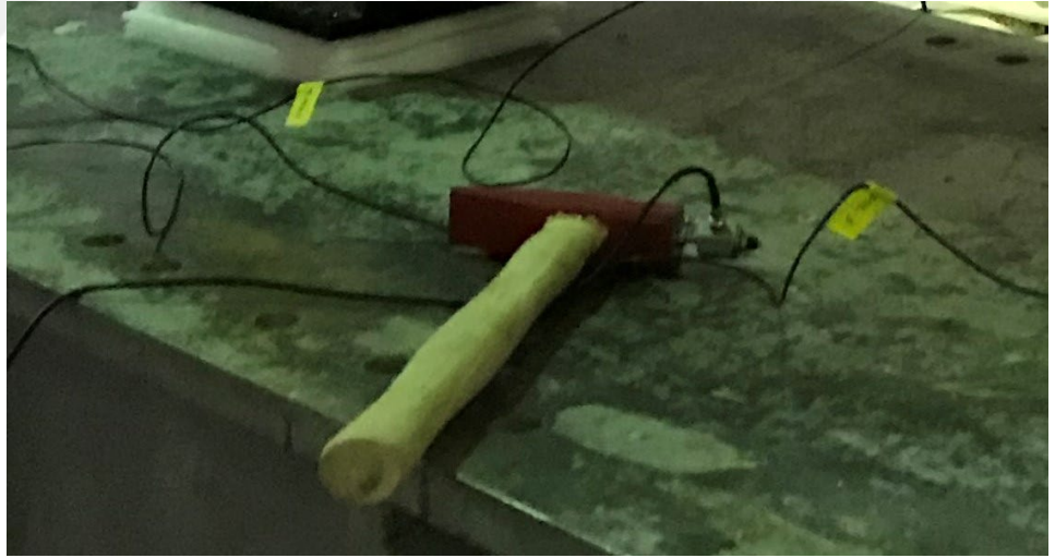
Şekil 5.7 Ucuna kuvvet sensörü bağlanmış darbe çekici
