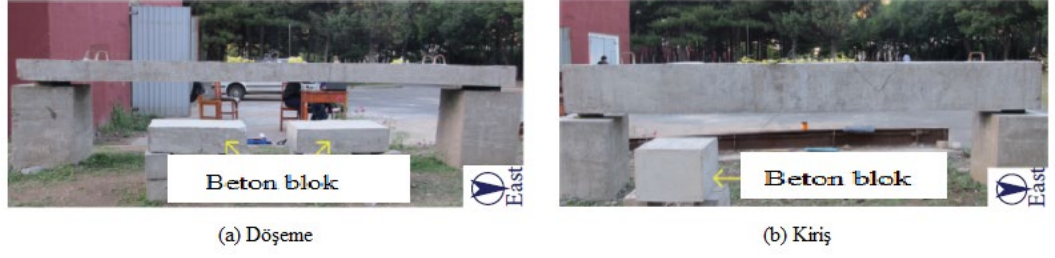
Şekil 1.9 İzleme süreci için oluşturulan numuneler ve test düzenekleri (Liu et al., 2016)
