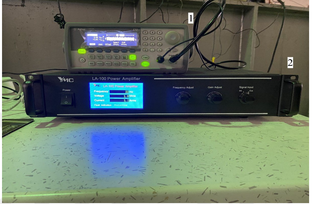
řekil 5.17 1) Agilent 33210A 10MHz Sinyal Üretici 2) YMC LA-100 Güç Amplifikatörü
