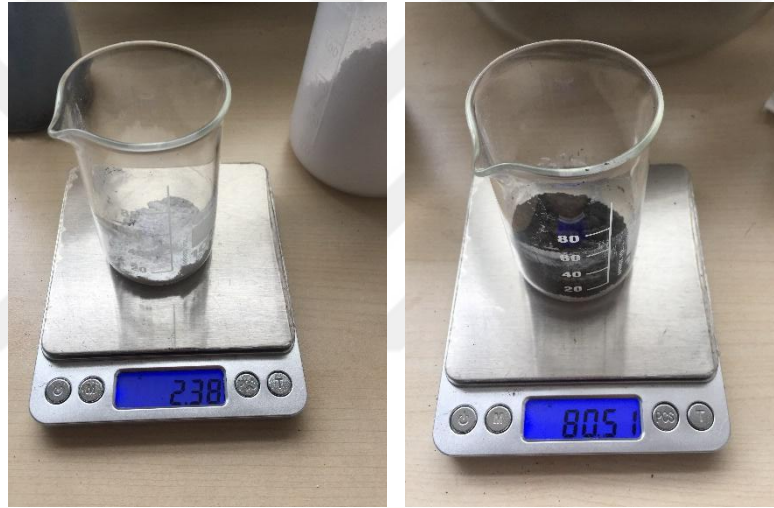
Şekil 3.5 T/M ile elektrot üretmek için gereken toz ağırlık ölçümleri.
