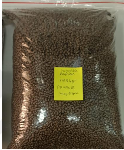
Şekil 2.1. %20 kenevir elyaf takviyeli polipropilen
