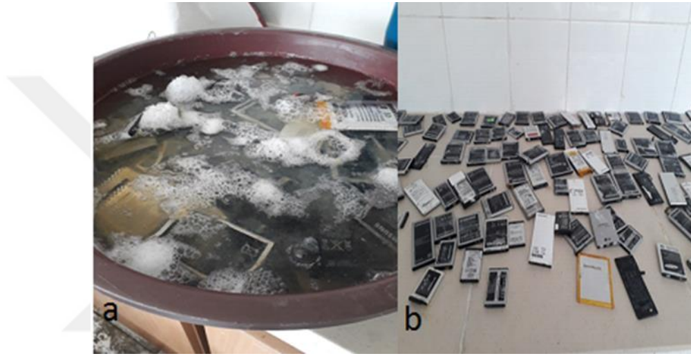
Şekil 9. (a)Atık bataryaların deşarj edilmesi, (b) deşarj edilen bataryaların kurutulması
