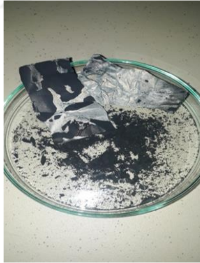
Şekil 14. 550 °C’de PVDF’in yakılmasıyla alüminyum folyodan ayrılan katot materyali
