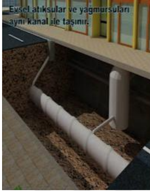
Şekil 2.3. Birleşik Sistem Diyagramı
