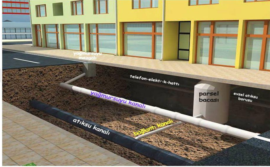
Şekil 2.2. Ayrık Sistem Diyagramı
