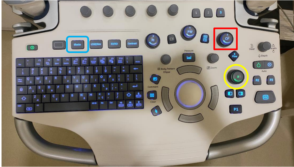
Şekil 3.2: USG cihazında B mod (sarı daire), renkli doppler (color flow, CF) (kırmızı kare) ve elastografi (mavi dikdörtgen) için seçim paneli.
