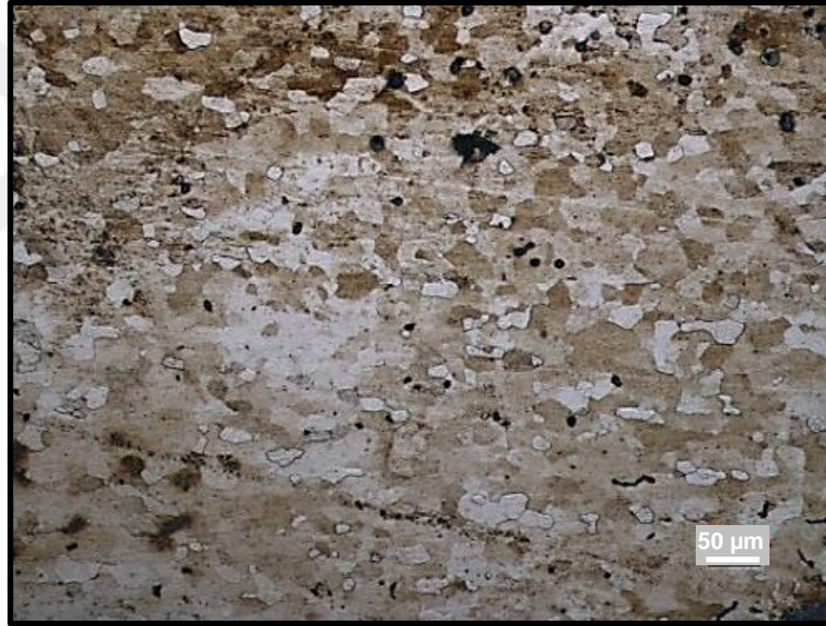
Şekil 7.19. IF 7114 çeliği ana malzeme mikroyapı görüntüsü.
