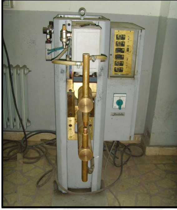
Şekil 6.3. Kaynak işlemlerinde kullanılan nokta direnç kaynak makinesi.
