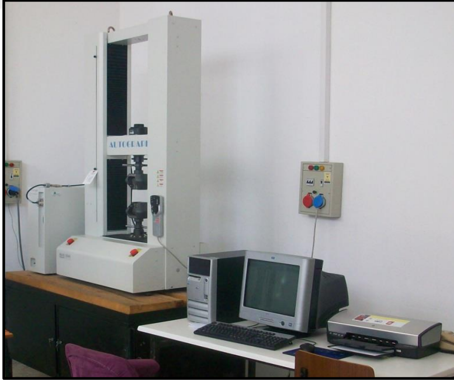
Şekil 6.7. Çekme-makaslama testi cihazı.
