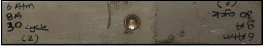
Şekil 6.6. Çekme-makaslama test numunesi.
