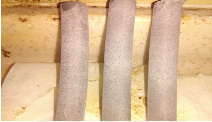
Şekil 3.2. Alternatif Kaplama ile Kaplı Yüksek Karbonlu Çelik Tel
