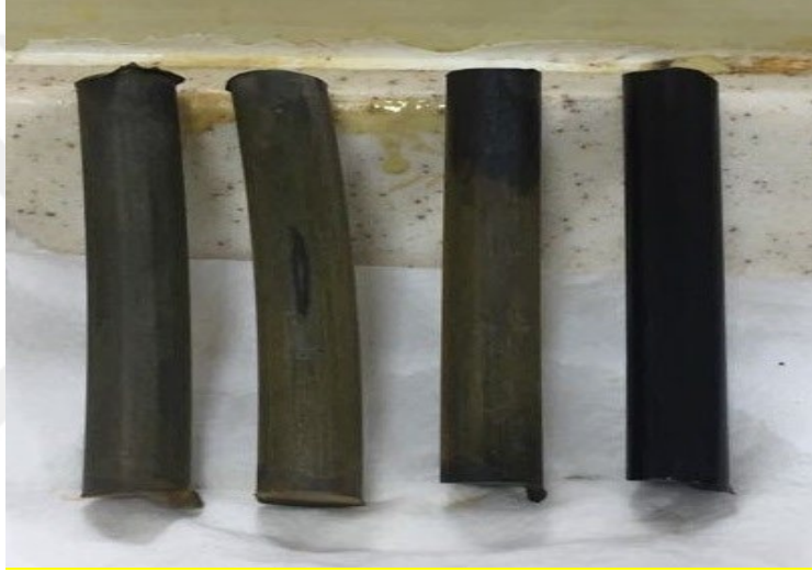
Şekil 3.1: Çinko Fosfat Kaplı Yüksek Karbonlu Çelik Tel
