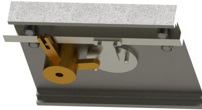
Şekil 4.6. Eksantrik mil ve lineer hareket tablası.
