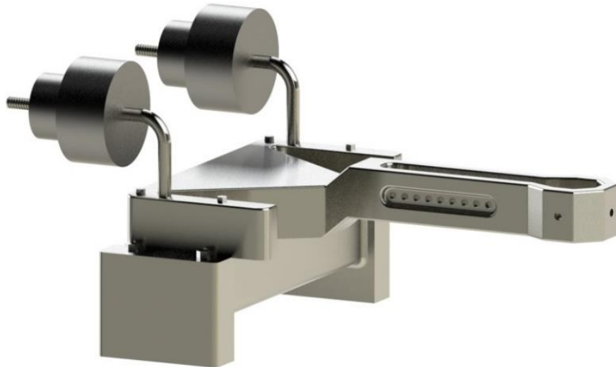
Şekil 4.4. Aşındırıcı ucun bağlandığı ve sabitlemek için yükün bağlandığı gövde.
