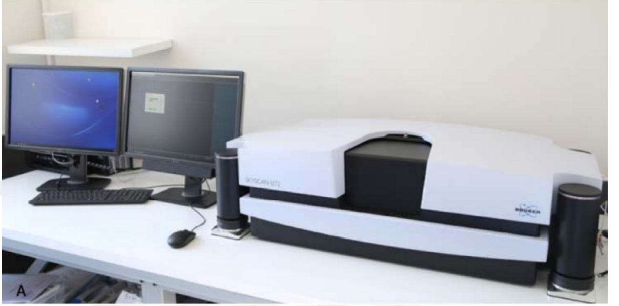
Şekil 3.6. Skyscan 1272 Micro-Bilgisayarlı Tomografi cihazı
