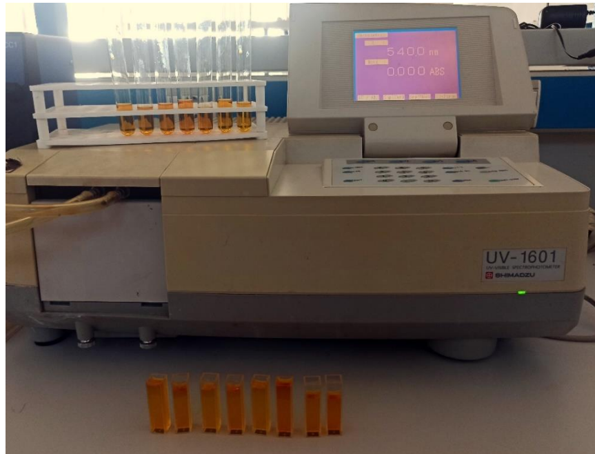
řekil 4.4. İndirgen řeker iin hazırlanan rneklerin spektrofotometre ile belirlenmesi
