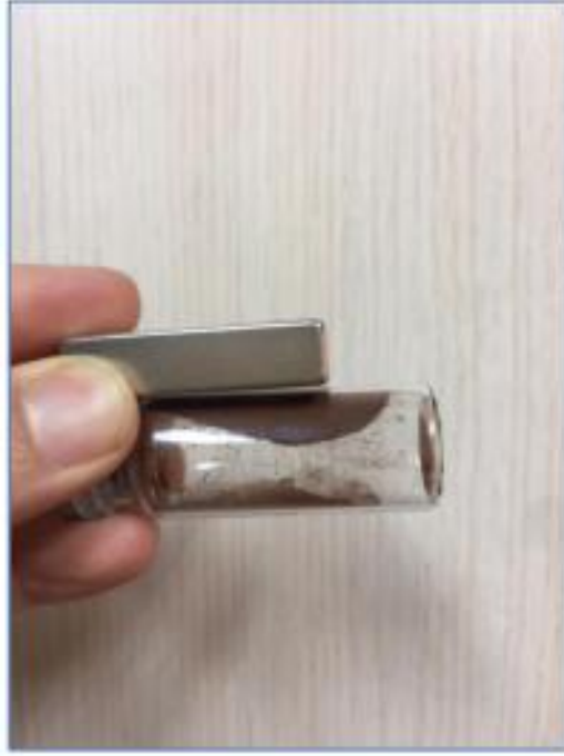
Şekil 3.5 : \text{Fe}_3\text{O}_4\text{-Ch-HCF} nanokompozitin magnetik özellik sergilemesi.
