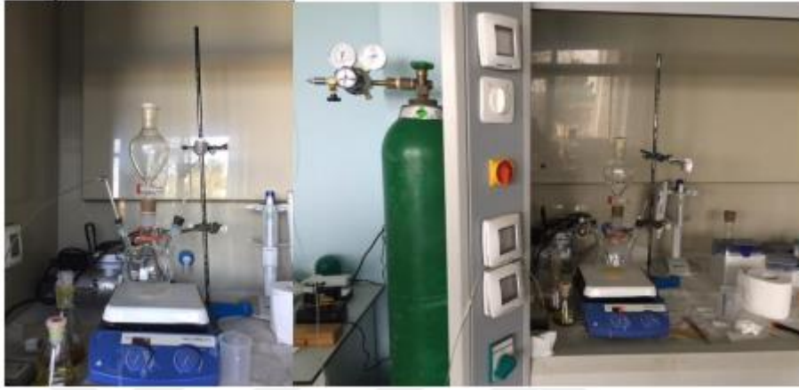
Şekil 3.3 : \text{N}_2 atmosferi sağlayan reaksiyon düzeneği.
