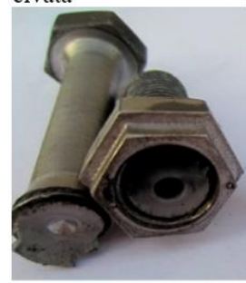
Eksenel delik+Düşük çap+Adımlı somun
