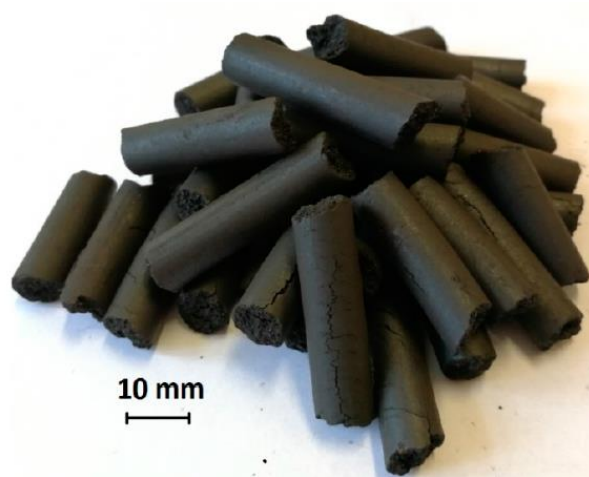
Şekil 1.7. Tek Vidalı Ekstrüderden Üretilen Peletler.
