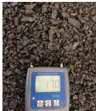
Şekil 3.13. Serilerek Kurutma Yapılan Atık Kömür Tozları.
