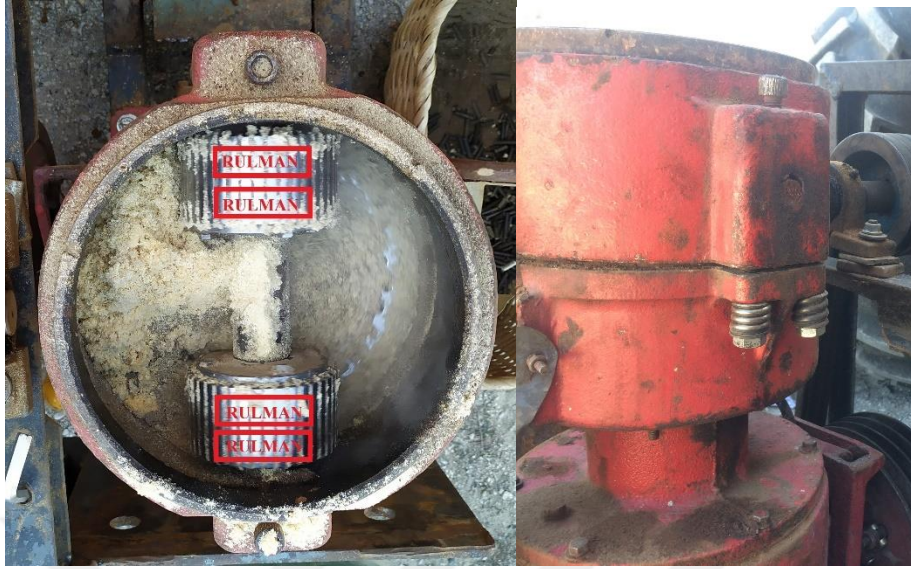
Şekil 3.2. Rulmanlar Ve Gövde Cıvatalarının Yerleşimi.
