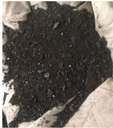
Şekil 3.15. Çeneli Kırıcıda Öğütülmüş Kömür Tozları.
