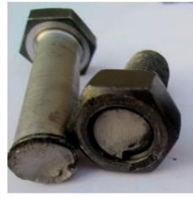
Gövde çapı azaltılmış cıvata
