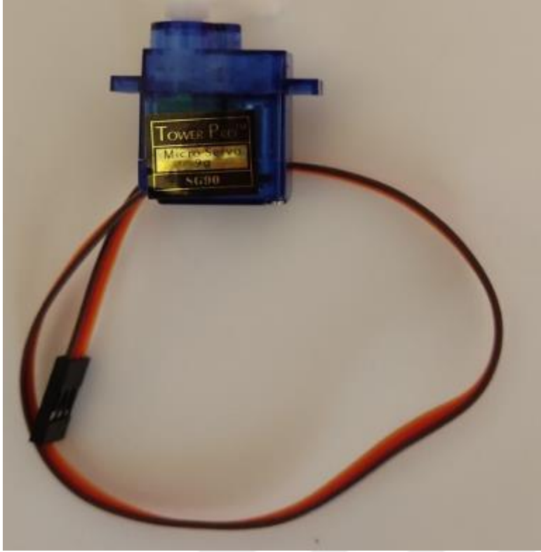
Şekil 4.11. SG90 Servo motor (Fotoğraf: Farid Yusifli, 2021).
