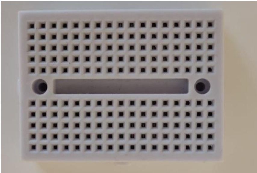
Şekil 4.12. Mini breadboard (Fotoğraf: Farid Yusifli, 2021).
