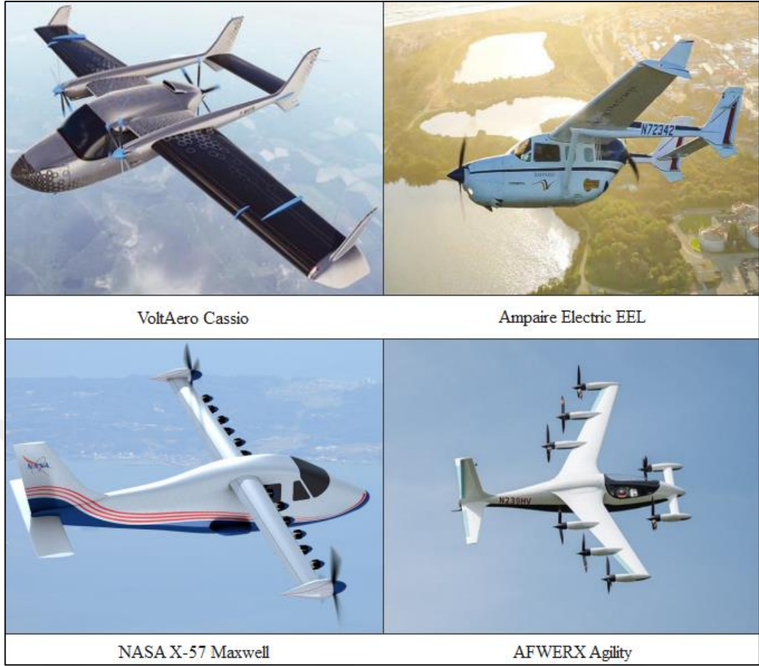
Şekil 2.16: Ön-arka konfigürasyonlu birden çok motora sahip bazı elektrikli uçak görselleri.
