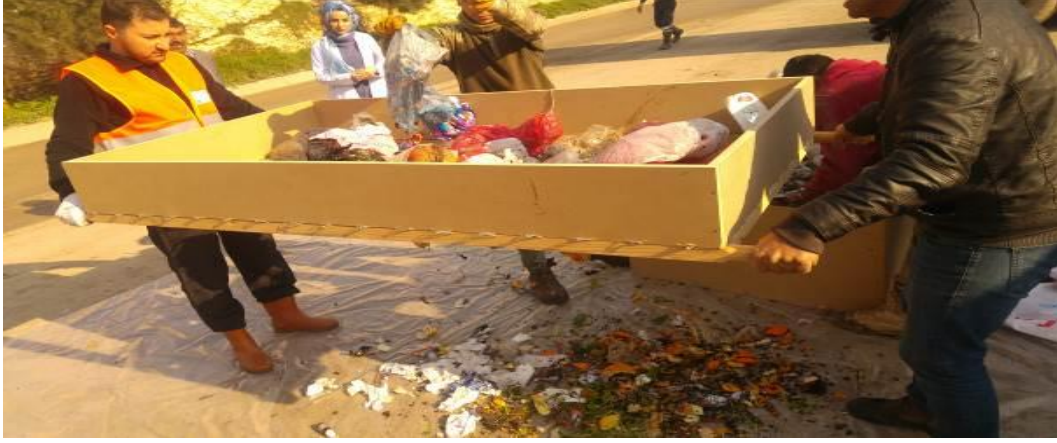
Şekil 4. 3. Katı Atığın eleme ve ayırma işlemleri
