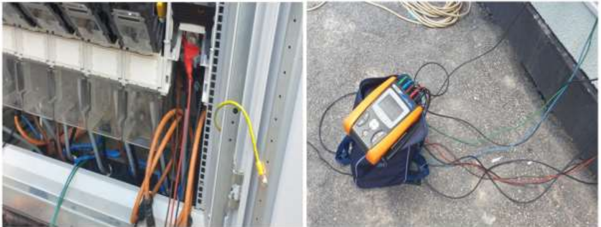
Şekil 4.1 PQA824 Güç Kalitesi Analizörü Ölçüm Bağlantısı - Monoblok
