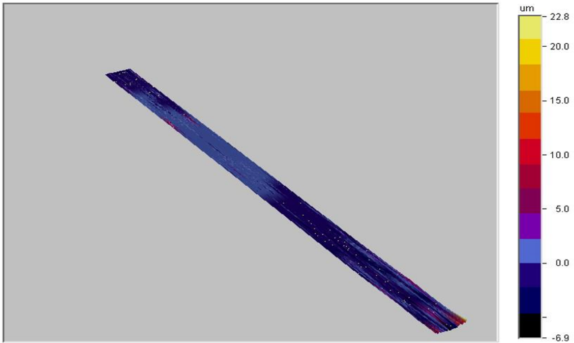
Şekil 4.18. Çizik aşınma sonrası N2 numunesinin çizilen kaplama yüzeyinde meydana gelen yüzey pürüzlülüğü
