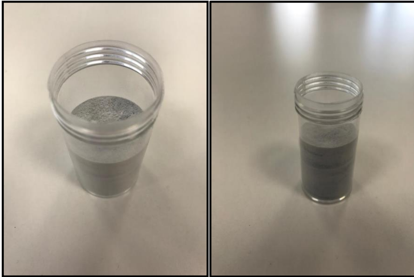
Şekil 3.12. rGO katkılı HA tozu.
