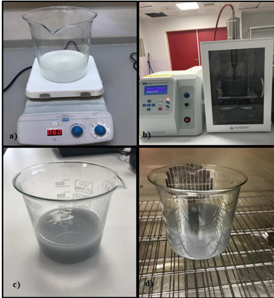
Şekil 3.14. a. agar ve saf suyun karıştırıcıda (YELLOW LINE-MSH B) karıştırılması b. HA eklendikten sonra solüsyonun ultrasonik homojenizatörde karıştırılması (MTI-MSK USP 3N) c. yoğunlaşan HA d. HA solüsyonunun etüvde (MAGMATHERM-MT1205) bekletilmesi.
