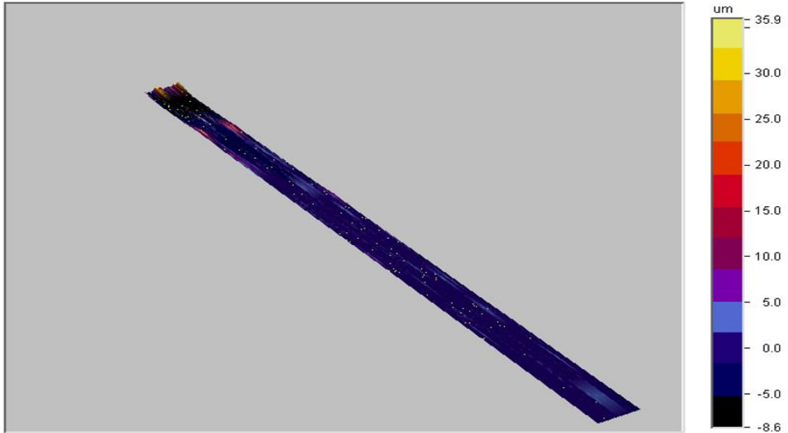
Şekil 4.20. Çizik aşınma sonrası N4 numunesinin çizilen kaplama yüzeyinde meydana gelen yüzey pürüzlülüğü
