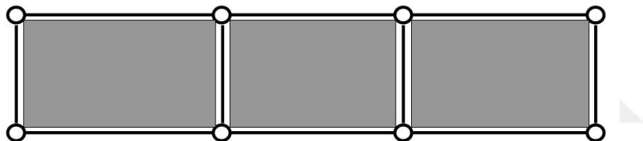
Рис. 2.3. Модель двух-поясной балки.
