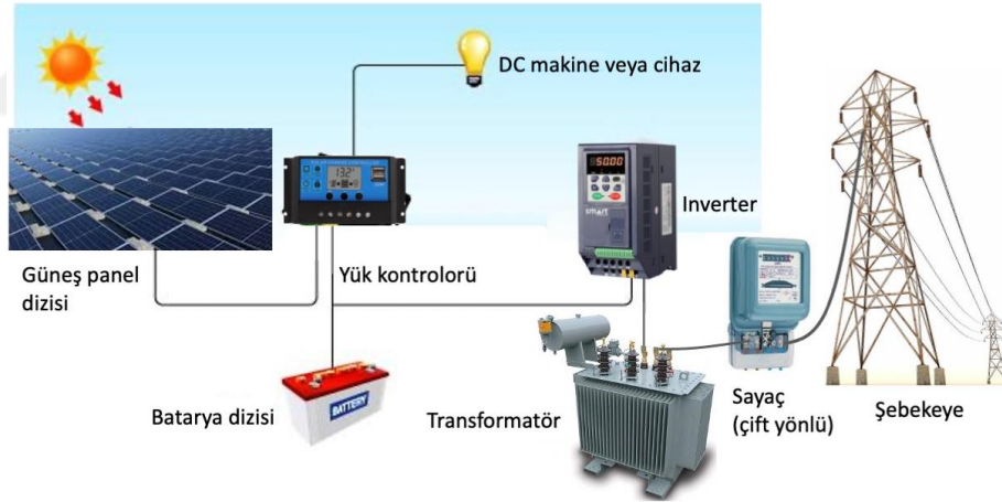
Şekil 2.9. Şebekeye bağlı FV güç üretim sisteminin elemanları
