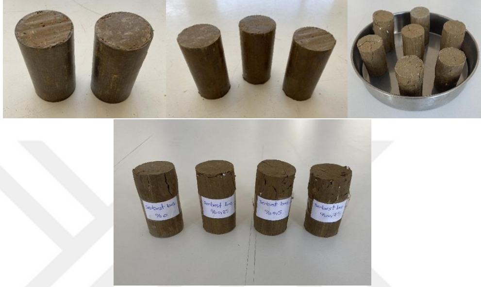
Şekil 2.15. serbest (tek eksenli) basınç deney numunelerinin hazırlanması ve deneyin yapılması.
