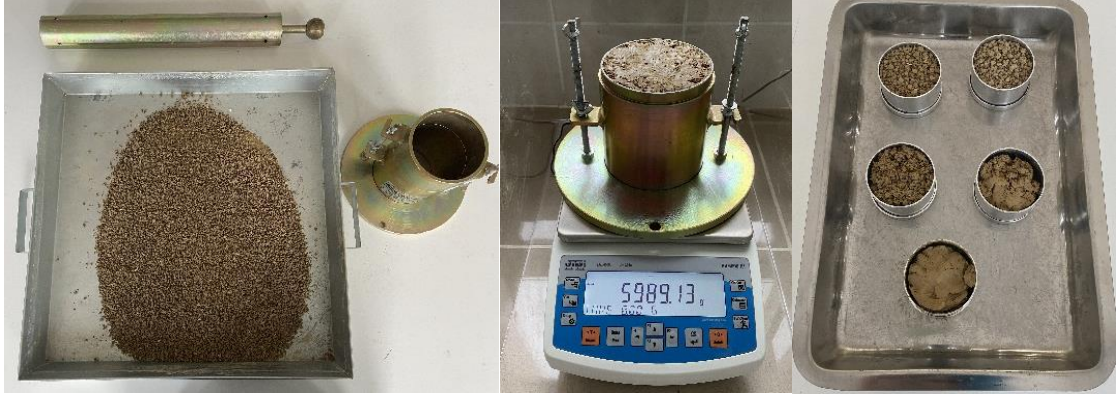
řekil 2.10. Proktor deney numunelerinin hazırlanması ve deneyin yapılıřı.
