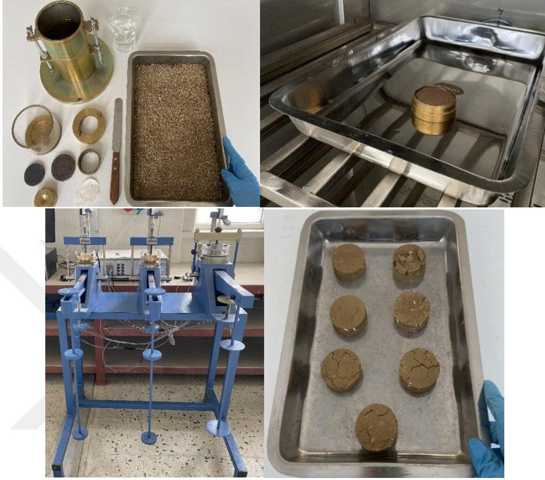
Şekil 2.14. Şişme deney numunelerinin hazırlanması ve deneyin yapılışı.
