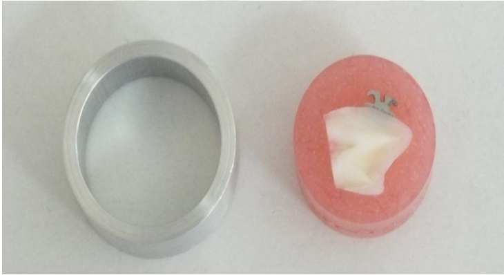
Şekil 3.13 Akrilik içerisine gömülmüş diş örneği
