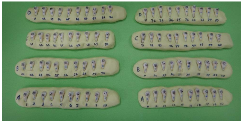
Şekil 3.12 Silikon kalıplar içine yerleştirilmiş diş grupları
