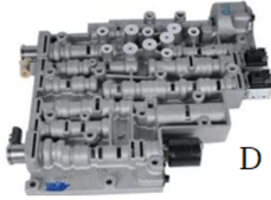
Şekil 1.6 Tam otomatik tipteki bir şanzımanın elemanları [6], [7], [8], [9], [10]
