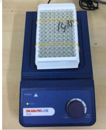
Şekil 3.6. Örneklerin çalkalayıcı cihazda inkübe edilmeleri (DLAB Scientific Inc.)
