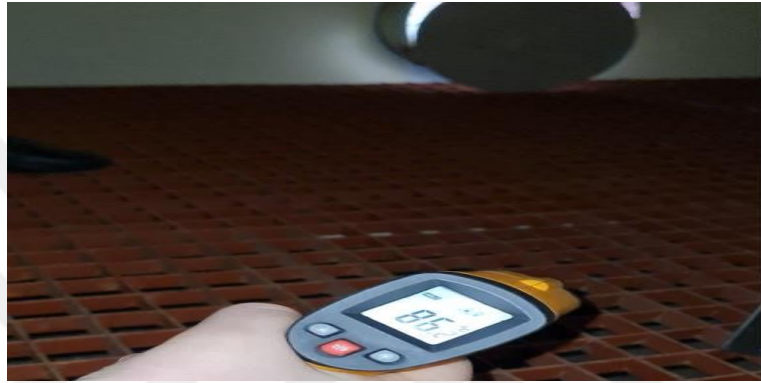
Şekil 4.27. % 30 Katkılı boya numunesi soğuma ölçüm işlemi bitiş
