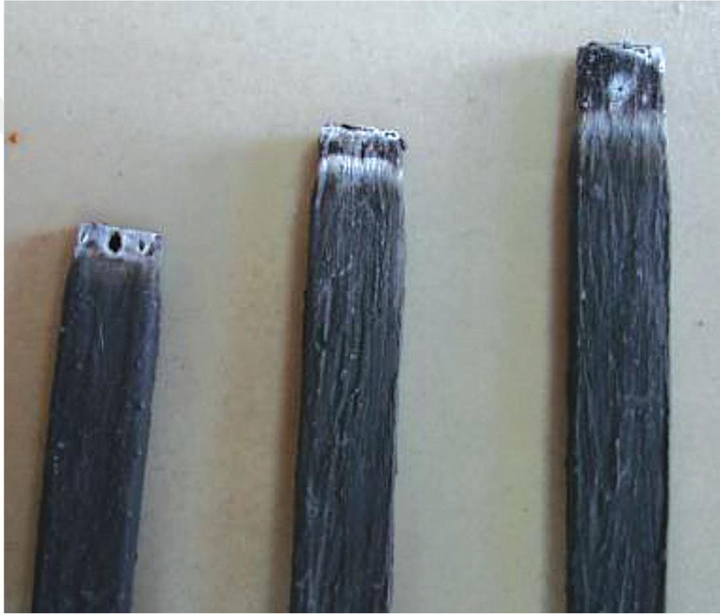
Şekil 4.10. %45, %50, %55 oksijen konsantrasyonu ile yakılan numuneler
