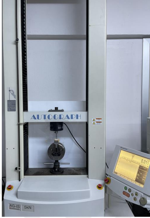
Şekil 3-22: Kırılma dayanımı testinde kullanılan cihaza yerleştirilmiş örneğin görünümü.
