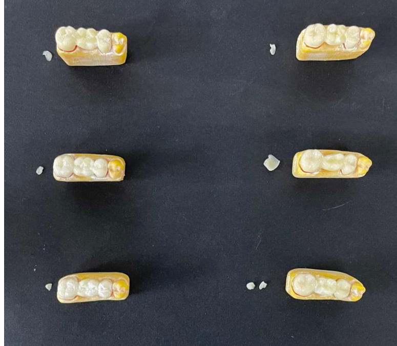
Şekil 3-23: Örneklerde kırık meydana geldikten sonraki görünüm.
