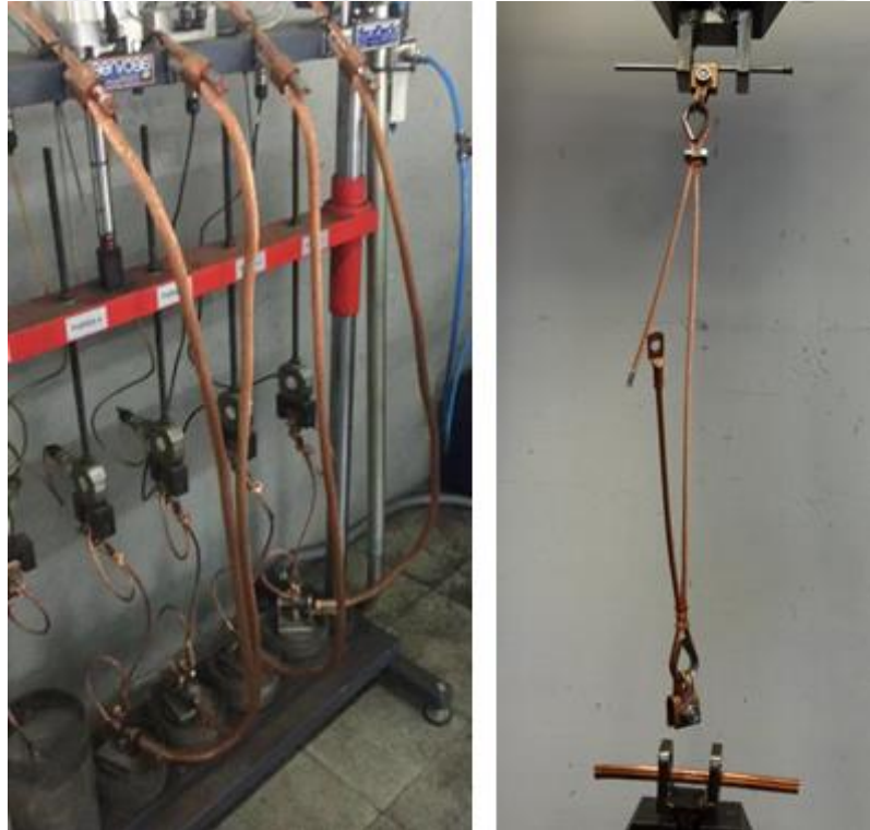
Görsel 2.5. Pandül döngü testi(sol), Pandül çekme testi(sağ)
